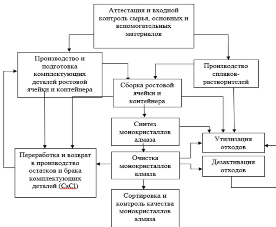
Рисунок 2- Блок- схема производства монокристаллов алмаза (основные стадии)
